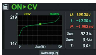
电池仿真运行-充电显示
