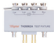
TH26062A 四端对测试夹具 ·工作频率: DC-100kHz ·最大直流偏置: \pm 42 V ·应用: 测试电动汽车用薄膜大容量DC_LINK电容
