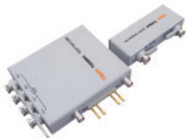
TH26063 四端对测试夹具 ·工作频率: DC-100kHz ·最大直流偏置: \pm 42 V ·应用: 测试螺栓电容器, DC_LINK电容
