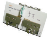
TH26108C 四端对贴片测试夹具 ·工作频率: DC-40 MHz ·最大偏置: \pm 42 V ·应用: SMD 器件, 尤其高频小电容 \leq 3 pF或小电感 \leq 1\mu H, 测试频率 \geq 100 kHz, 且对D和Q要求高的器件
