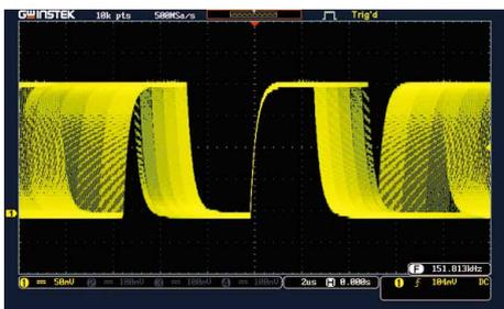
GDS-1000B 系列示波器虽然在市场上属于通用基础型示波器，但它却具备了高达每秒 110,000 次的波形更新率，使用者可以输入一个快速的调频载波信号如图所示，通常在传统的数字示波器下量测此信号会出现不流畅的暂留现象，无法清楚地呈现调频信号的调制变化过程。然而在 GDS-1000B 示波器上则无此问题发生，它不仅可流畅地呈现波形调制的变化以外，亦可层次分明地显示变化的细节。
