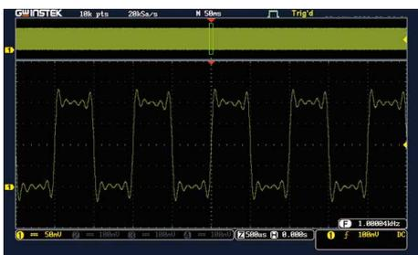
GDS-1000B 示波器每通道独立 10M 的记忆长度，在进行基础量测的应用时就能轻而易举地掌握波形的细节，当使用者输入长串序列的正弦波信号时，在时间档位 1ms/div 时，在将波形细部进行放大不会因为存储器点数不够而出现严重的失真现象，当 GDS-1000B 示波器将波形放大至 20ns/div 时，波形的细节依然可清楚地显现，这正是这款示波器的真正价值所在。
