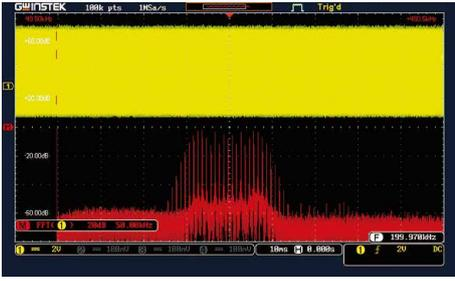
GDS-1000B 系列示波器在快速傅立叶转换的数学分析模式中具备了 1M 记忆长度摄取模式。在传统的各系列数字示波器当中，FFT 模式通常只具备 1000 点的摄取长度，所以在频域模式的表现上较不能呈现各频谱量的强度分布细节，但是今天 GDS-1000B 系列示波器率先提供了 1M 摄取点的显示模式，不但能清楚地表现频谱量的显示细节，同时加上高达每秒 110,000 次的波形更新率，使得 FFT 分析模式就如同在使用一台实时频谱分析仪一般的快速而精准，大幅提升了示波器在频域分析的信号处理能力。图中是一个载波为 200KHz、调制为 40KHz 以及频偏为 5KHz 的标准调频信号，因为 GDS-1000B 具备了 1M 摄取的记忆深度，所以 5KHz 的频偏间格可以清楚地显示出来，让工程师可充分地掌握量测的细节。
