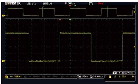
当工程师在观察细微的波形量测时，GDS-1000B 示波器提供了波形局部放大的功能，将其视窗分成上下两个部分，上面视窗为长时间波形的资料记录以及标示着需要放大波形的的位置关系，下方的视窗则是局部波形的放大图示，这不仅能够提供观察者相对波形的比较，亦能详细地掌握不同时间点之波形细节。另外，GDS-1000B 也同时提供了播放 / 暂停的功能。特别是在长时间的波形监控时，播放功能能帮助工程师快速地浏览整段待测之波形，亦能快速地寻找出波形问题之所在。
