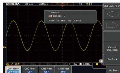
在电路的测试中,工程师在测量信号时经常被噪音干扰困扰。GDS-1000B 系列示波器提供了数字滤波功能选项,该选项可以设置各个通道为高通或低通滤波器。滤波器的频率可以根据需求调整。滤波器每个通道的参数还可以设置跟踪,可用于设置滤波器频率相同所有频道。
