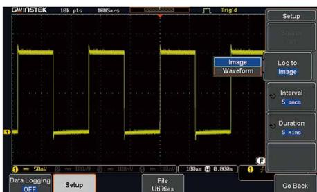
GDS-1000B 示波器具备选配资料记录器功能，其功能可让使用者长时间观测纪录波形的变化以确保产品的可靠度以及稳定性。资料纪录功能可依测试需求，设定储存档案的期间与间隔。纪录时间可选择 5 分钟至 100 小时；储存间隔最短为 5 秒。储存资料可选择储存波形或是点资料 CSV 档案。储存的资料亦可选择存于 USB 随身碟、GDS-1000B 内部或是透过 LAN 储存于远端的计算机内，是一个即为人性化的进阶量测管理工具。
