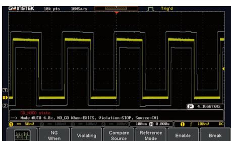
在产业界量产产品时，产品的良率判定成为了一个重要的课题。GDS-1000B 示波器提供了 Go/NoGo 分析功能，目的就是加速产品的良率分析。如右图所示，对于一个待测波形而言，Go/NoGo 分析功能可以提供一个标准的波形模板，其可随心所欲地调整模板的大小，只要待测波形出现异常状况而碰到模板时，就会产生不良品的讯息，这不仅提供了产线生产一个重要的量测利器之外，对于研发工程师来说，Go/NoGo 功能针对长时间地监控待测波形也是非常方便的工具。
