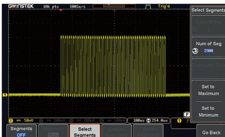
GDS-1000B 示波器可选配分段记忆体功能。如图中类似雷达形式的簇发波形。传统的示波器将消耗大量的内存空间来检索整个部分的波形。那是因为突然的停滞时间波形通常将消耗大量内存空间。波形搜索功能将内存划分为几个部分。能保持足够的内存空间高采样率。通过这样做，用户可以抓取波形的有效部分从而提高内存的使用价值。
