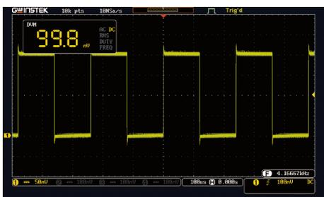
一般研发工程师在进行电路量测以及除错时，不仅需要用到示波器，基础电表也是必备的工具之一。GDS-1000B 示波器具备数位电压表的功能，提供三位电压表及五位频率计的功能工程师只要按下选配的按键，即可在选单中将数位电压表的功能呼叫出来。其可实时地量测直流、交流电压，占空比以及频率，让工程师除了可以量测波形之外，亦能监控电路板上各元件的电气参数特性，实在是一个分常方便的工具。
