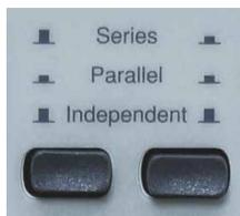
GPE-3060/6030 除了每个通道之间的独立输出外，还可以执行串并联自动连接跟踪功能。通过并联或串联功能，电源的输出可以控制在 30V/12A ( 并联 ) ( GPE-3060 ) 或 120V/3A ( 串联 ) ( GPE-6030 )，此功能可用于 CH1/CH2。
