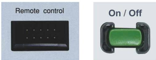
GPE-3060/6030 提供输出开 / 关功能。该功能可以避免 DUT 连接到电源时预输出造成的不必要损坏。用户可以提前设置电压和电流参数，确认所有连接已完成，并通过前面板手动执行输出开 / 关功能。此外，该系列还提供了一个简单的模拟控制功能，通过后面板上的远程控制端子控制外部输出的开 / 关。
