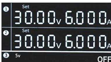
在测量分辨率方面，GPE-3060 提供 10mV/2mA，GPE-6030 提供 20mV/1mA，回读精度为 30mV/10mA。GPE-3060/6030 确保功率输出纯净稳定。
