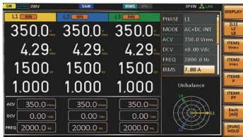
ASR-6000 系列具有多样化的输出功能，包括三种模式：1P2W、1P3W 和 3P4W。相电压的最大输出为 350Vrms，线电压的最大输出为 700Vrms。交流三相输出(3P4W)模式下，每个相位都支持独立输出设定。以 ASR-6600 为例，每个相位最大输出达 2kVA，支持最多三个待测物电源测试，以满足服务器电源模块、电动车充电器、不断电电源系统等高功率交流电源产品的测试需求。
