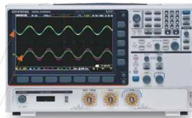
ASR-6000 系列提供双通道电压和电流监测，允许实时输出各相电压和电流信号到示波器进行测量。
