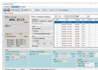
PC 软件 DMM-Viewer2，适用于任何 GDM-906X 所提供的计算机通信接口（RS-232C/LAN/USB/GPIB），以便于进行长时间数据采集。该软件除了可以控制 GDM-906X 的设置外，对于采集的数据，可采取观测模式或记录模式。观测模式，测量结果直接以趋势图或直方图的结果呈现，不进行储存；记录模式，直接保存测量数据进入记录文件。除此之外，GDM-906X 也提供 LabVIEW driver。
