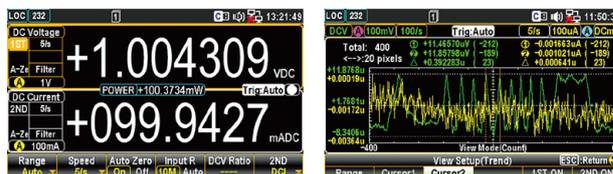
双测量功能，一直是固纬数字电表的一项特色，允许同时执行两个测量功能，并分别显示测试结果，大大提高了多功能测试速度。
