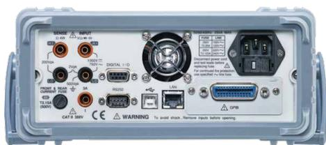
对于系统整合应用，GDM-906X 搭配有 RS-232C、USB 和 LAN 作为标准通信接口，GPIB 则为选购项目（客户可自行安装），以符合不同使用上的需要。通过 USB/LAN/GPIB 通讯，传输可达 10k 读数 / 秒（GDM-9061），或 1k 读数 / 秒（GDM-9060）的数据。
