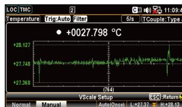
GDM-906X 可进行温度测量，适用热敏电阻、RTD 以及热电偶的各种温度传感器。GDM-906X 的温度测量支持常用的热电偶类型（例如：J/T/K...等），使用电压测量端子作为热电偶输入，并根据电压波动计算温度；若再配合机器内存及趋势图功能，可作为温度记录器使用。
