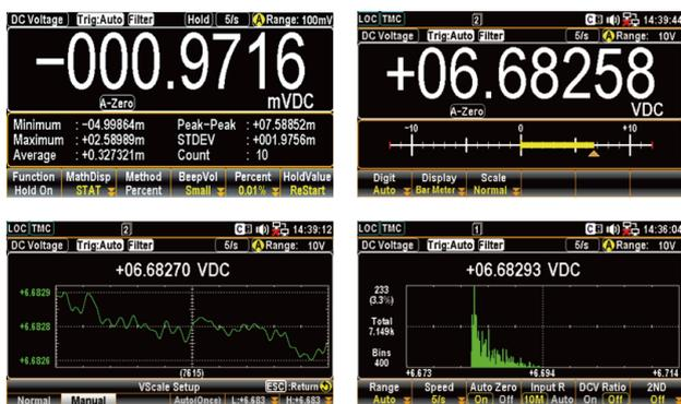
除标准的数值显示模式外，还提供条形图、趋势图与直方图等多种图形化功能，让测量结果不仅仅是一串数字，而是掌握测量全貌的迅速洞察。
