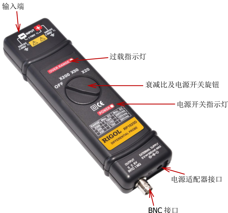
图 1 RP1025D 高压差分探头
