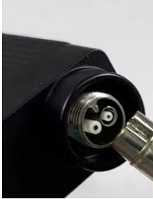
2. 顺时针螺旋拧紧衰减电缆的锁紧螺母。
