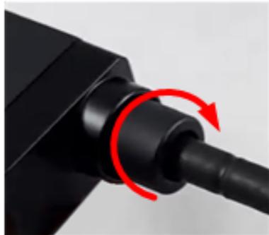
要拆下衰减电缆，请先逆时针拧松并取下衰减电缆的锁紧螺母，然后手持衰减电缆的硬质接口将衰减电缆取下，此过程切勿拉拽衰减电缆。
