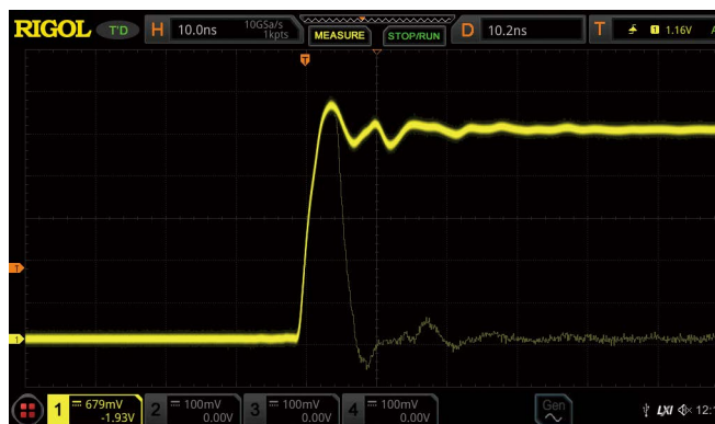
高刷新率模式下捕获偶发异常信号
