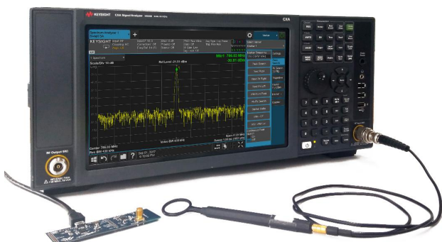
图 8. 使用近场探头 (N9311X-100) 检测 EMI 发射
